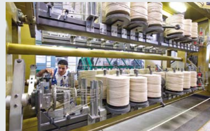
Modernste Technik: Schlagmaschine – Hier läuft alles zusammen, das Garn zum Seil. Here comes everything together, from fibre to rope.
